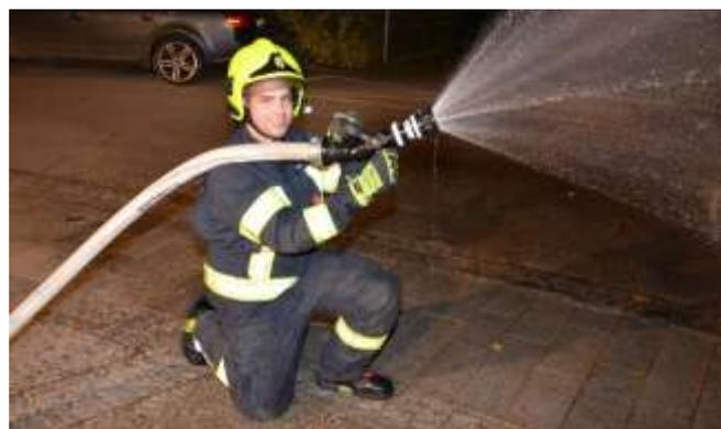
Dieser Typ von Strahlrohr wird schon seit längerer Zeit in den USA verwendet und ist daher vielen aus Filmen bekannt. Dieses hat besonders beim Brandeinsatz mit schwerem Atemschutz große Vorteile. So kann zum Beispiel durch Verstellen der Durchflussmenge die Löschwirkung optimiert und der Wasserschaden in Wohnhäusern so gering wie möglich gehalten werden.
