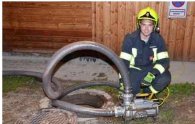
Wie die Hochwässer der vergangenen Zeit gezeigt haben, sind genügend Tauchpumpen zur Hilfe bei Naturkatastrophen absolut notwendig. Um auch sehr stark verschmutztes Wasser oder sogar Schlamm pumpen zu können, wurde die Spezialpumpe „Chiemsee“ angeschafft. Diese Pumpe wird mit anderen Hochwassergerätschaften auf einem Rollcontainer des neuen Logistikfahrzeuges mitgeführt. Durch die spezielle Bauform können Materialien mit Korngrößen bis 65mm gefördert werden.
