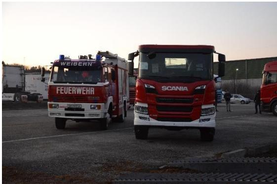
Dabei handelt es sich um einen Scania P360 mit einem 8-Gang Automatikgetriebe und Allradantrieb. Der Fünfzylinder-Motor hat eine Leistung von 360PS bei 9 Liter Hubraum. Um die Sicht bei Nachtfahrten zu optimieren, verfügt das neue Einsatzfahrzeug über LED-Scheinwerfer.
